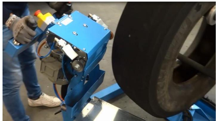
Commande bi-manuelle sécurisée pour rotation des outils, contrôle de rotation du pneu (2 sens) et inclinaison (+/- 20°)
